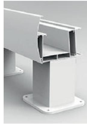
Die Pfostenträger in unserem System sind 110 mm x 110 mm groß in moderner Form. Die Flanschdicke an der Basis beträgt 10 mm und es gibt spezielle Befestigungslöcher.
